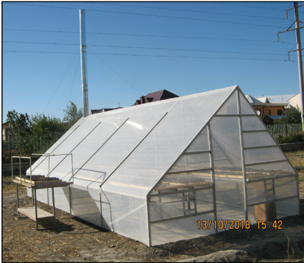
1-расм. Изображение усовершенствованного сушителя парникового типа.
